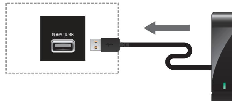
※USBハブ(セルフパワータイプ)を使用すれば、4台までのハードディスクを同時に接続できます。(本機に登録できるのは8台までです)
