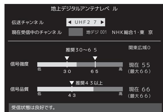
4. アンテナをゆっくり動かして「アンテナレベル」の数値が最大となるように調整します。
