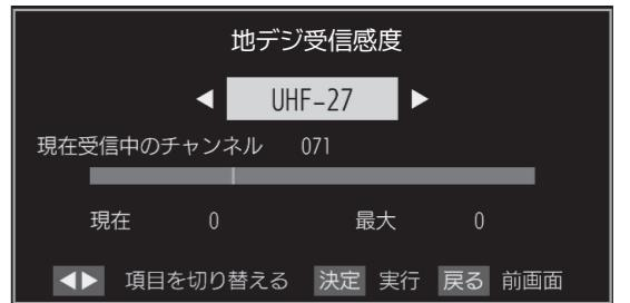
4. アンテナをゆっくり動かして「アンテナレベル」の数値が最大となるように調整します。
